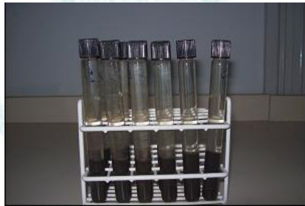
Foto 1. Tubos con muestras de suelo para la incubación en anaerobiosis.
